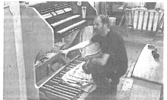
Orgelbauer Tobias Schramm bei der Einregulierung der Schwellmechanik
