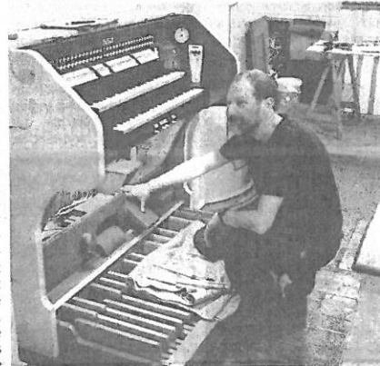
Tobias Schramm bei der Einregulierung der Schwellmechanik. Fotos: rb
